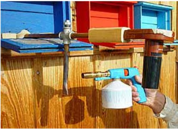
Foto 4: Varrogaz Gas-Verdampfungsgerät mit Ventilator
